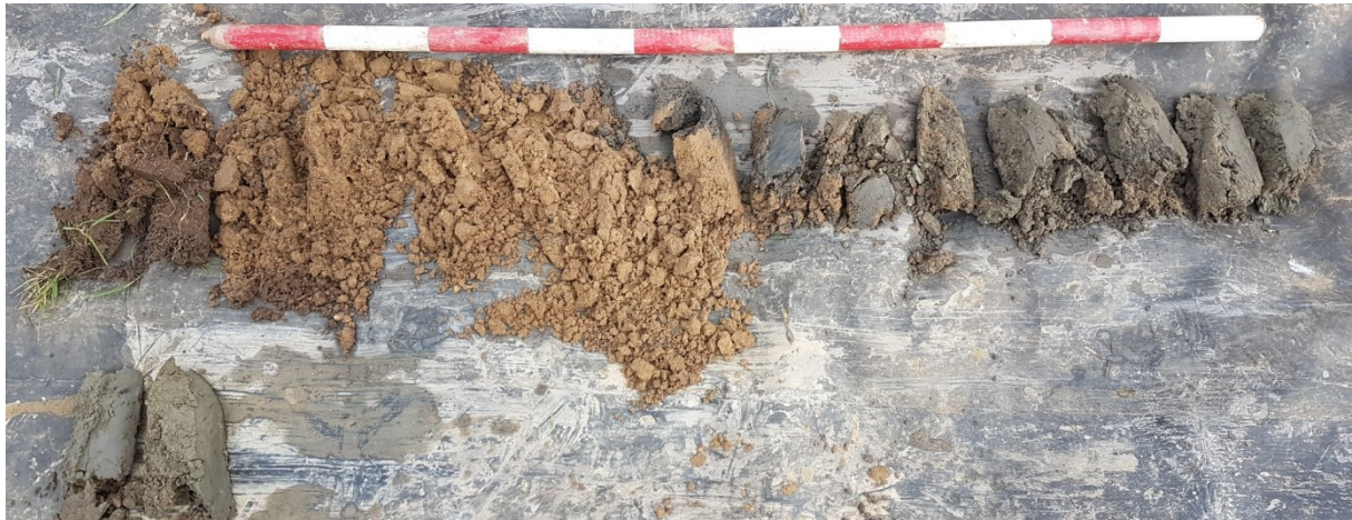
Figuur 19: Foto van boring 1, uitgelegd per meter van links boven naar rechts onder.
