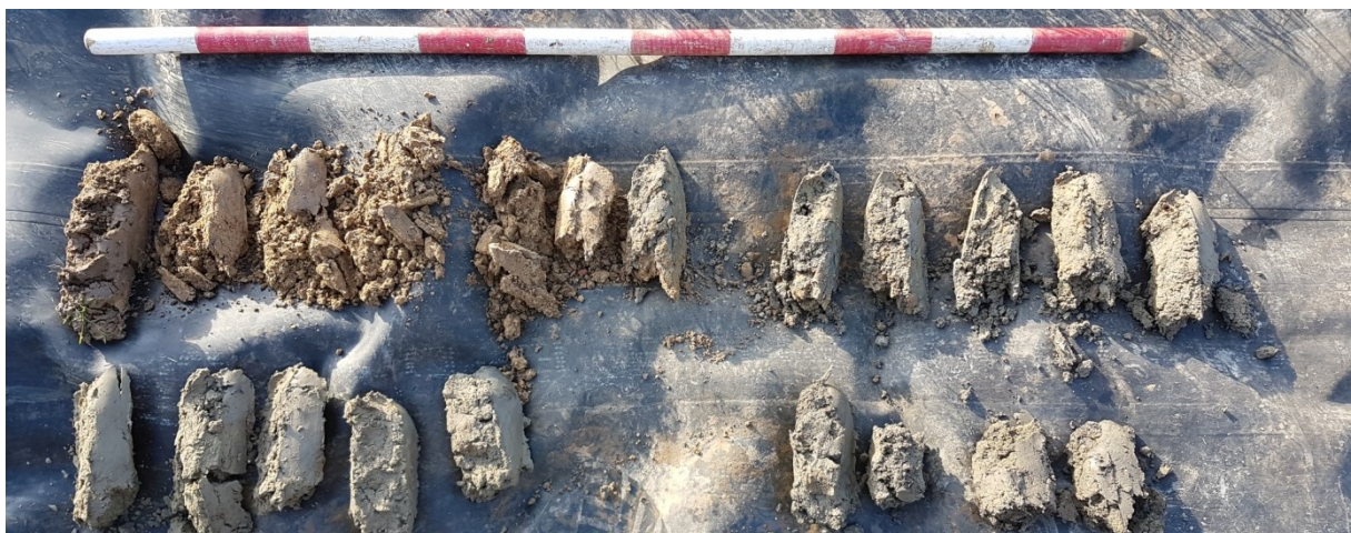
Figuur 21: Foto van boring 2, uitgelegd per meter van links boven naar rechts onder.
