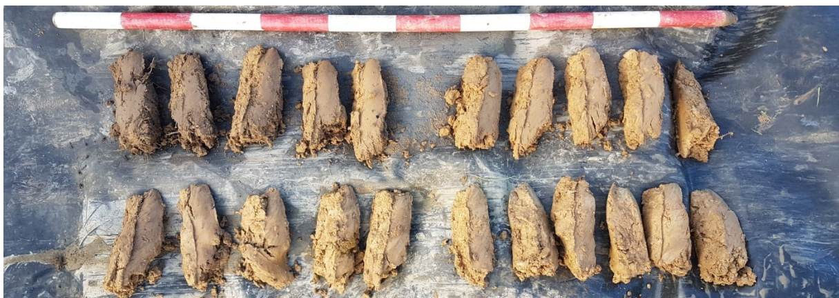
Figuur 20: Foto van boring 5, uitgelegd per meter van links boven naar rechts onder.
