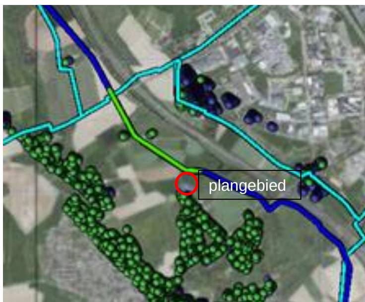
Figuur 2.7: Kilometer leiding met hoogste overschrijdingsfactor (in groen weergegeven), ná planrealisatie
