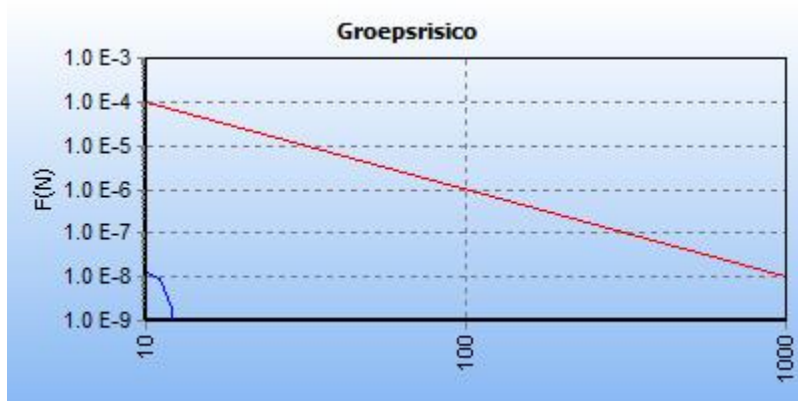
Figuur 2.8: fN-curve buisleiding A-578-deel-1, voor planrealisatie
