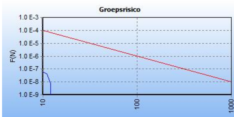
Figuur 2.14: fN-curve buisleiding A-645-deel-1, voor planrealisatie
