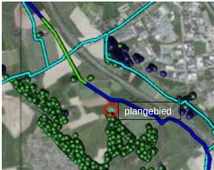
Figuur 2.5: Kilometer leiding met hoogste overschrijdingsfactor (in groen weergegeven), voor planrealisatie
