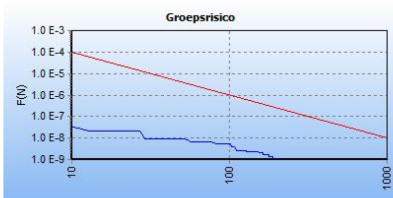
Figuur 2.9: fN-curve buisleiding A-578-deel-1, ná planrealisatie
