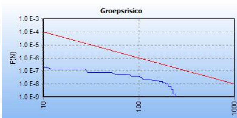
Figuur 2.15: fN-curve buisleiding A-645-deel-1, ná planrealisatie
