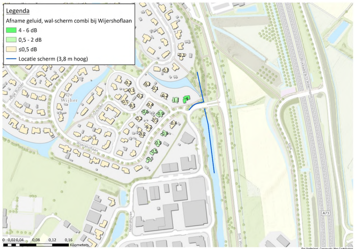
Figuur B6.2 Locatie van de maatregel (scherm-wal combinatie) bij de wijkontsluiting, inclusief geluidafname als gevolg van de maatregel.
