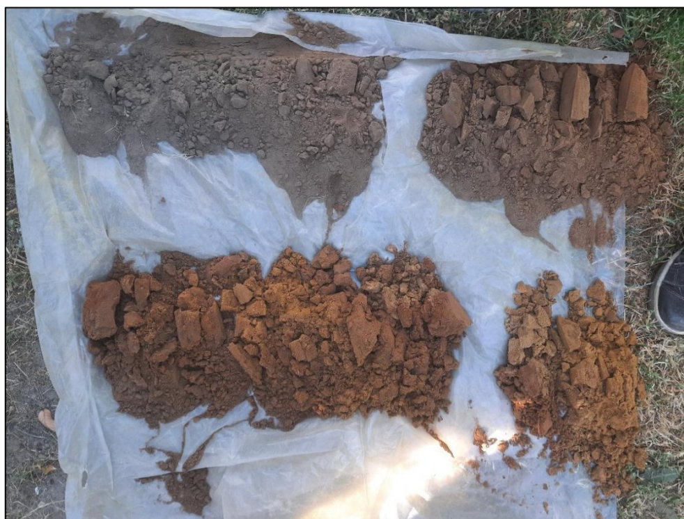
Figuur 10. Foto van boring 6. De leesrichting is van linksboven naar rechtsonder (0 – 180 centimeter) (Foto: 20 juni 2023).
