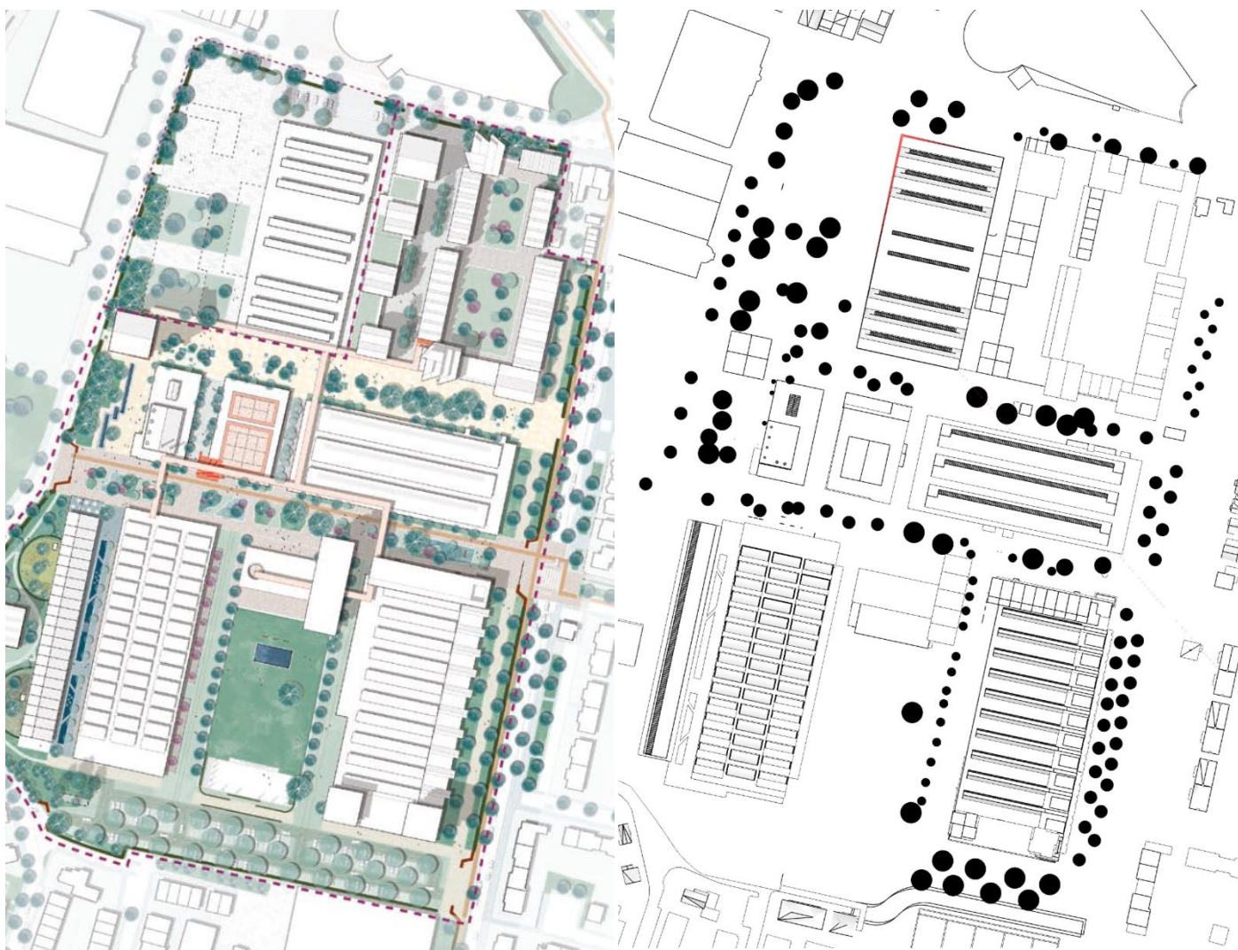
Figuur 11: Groenontwerp transformatie (links) en modelvorming CFD simulatie met bomen in zwart (rechts)
