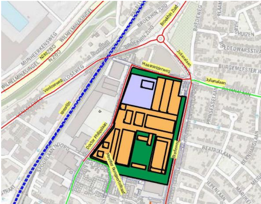
Figuur 17: Ligging van de wegen met een geluidzone (rood) en zonder geluidzone (groen) en spoorlijn (blauwe stippenlijn)
