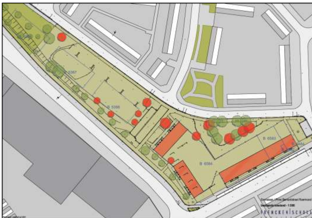
Figuur 2.4: Aanduiding van de te slopen bebouwing en de te kappen bomen
