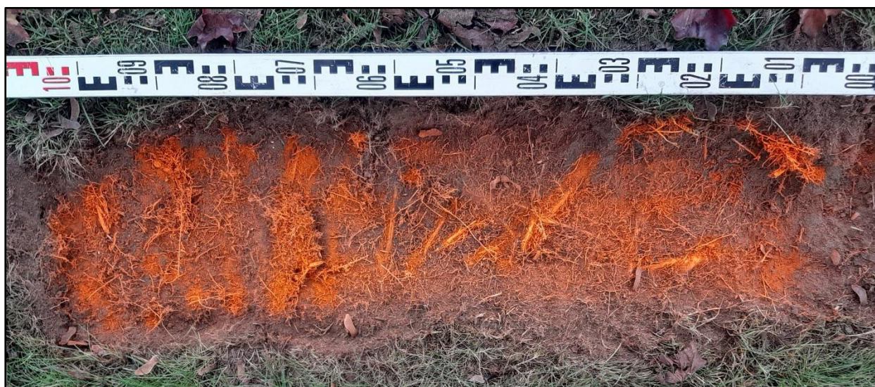
Figuur 13. Beworteling in proefsleuf op de locatie van het nieuwe trottoir nabij boom 8.
