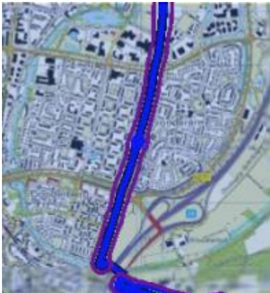
Figuur 3.1 Plaatsgebonden risico voor leiding-Z-509-01-deel-1 van de Gasunie
