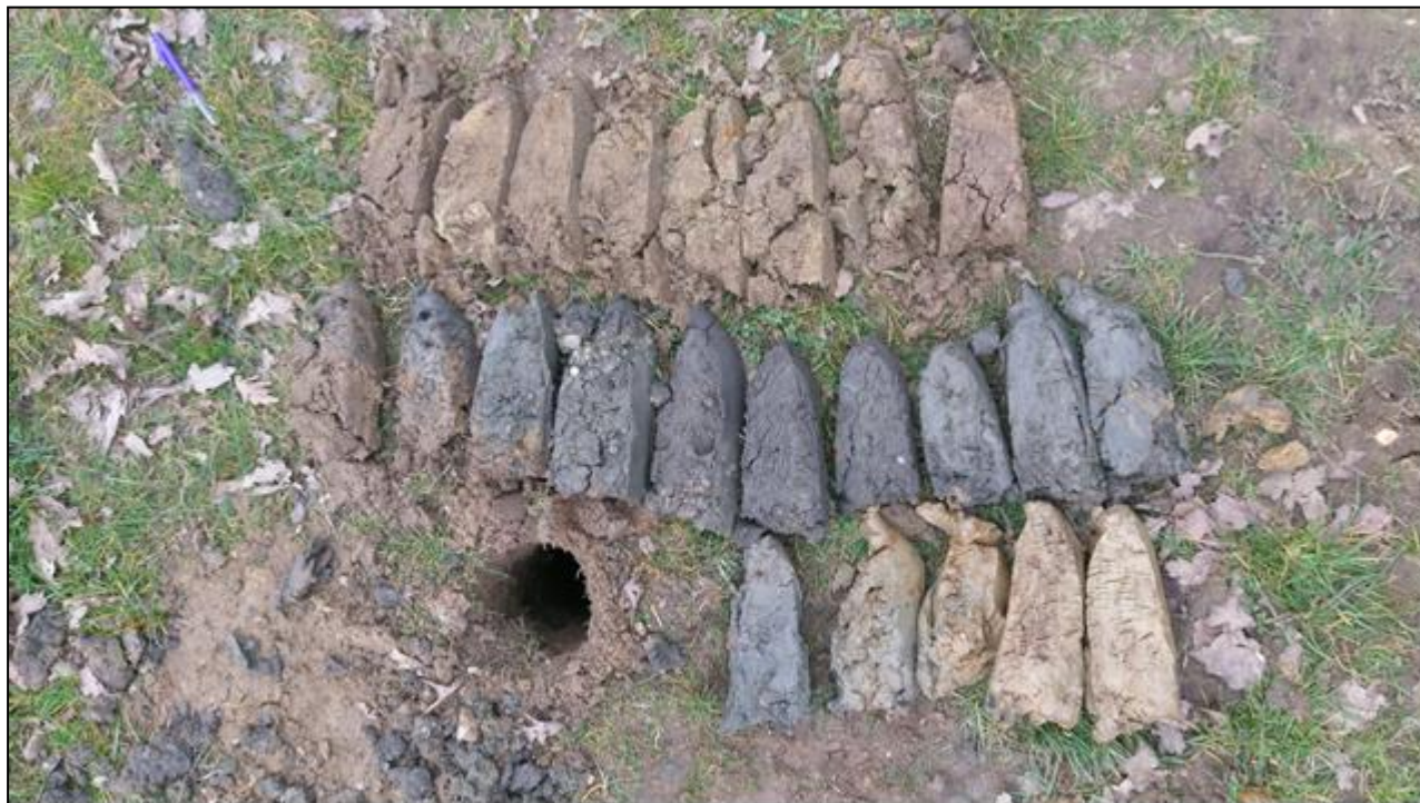
Figuur 7: Het boorprofiel van de sterk afwijkende boring 5, met tot grote diepte een grijze löss.
