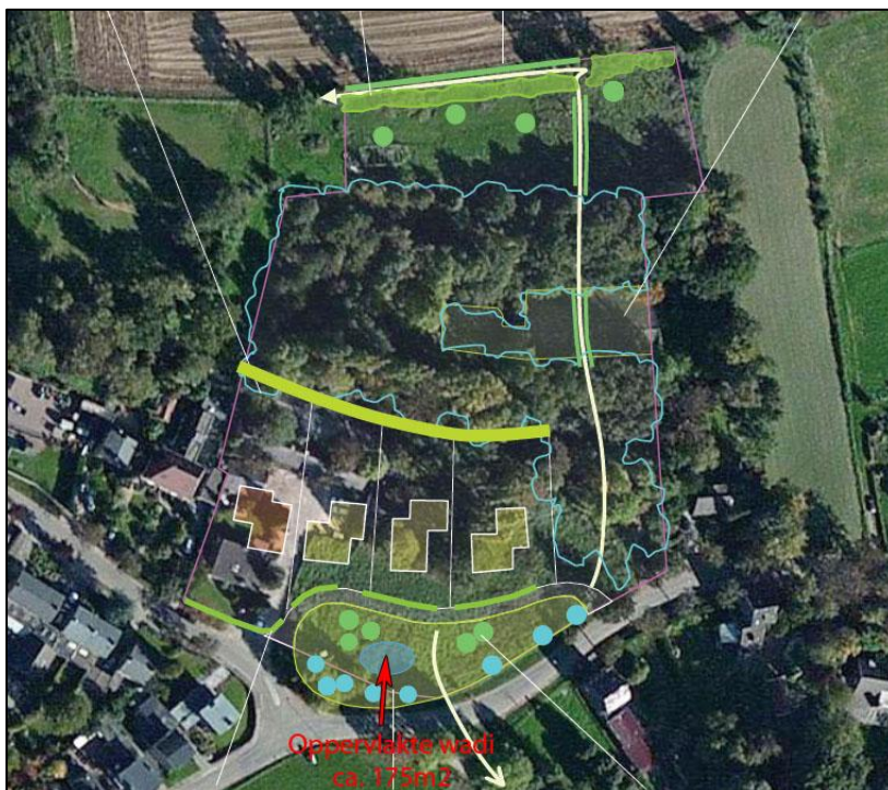
Figuur 21: infiltratievoorziening hemelwater (wadi)
