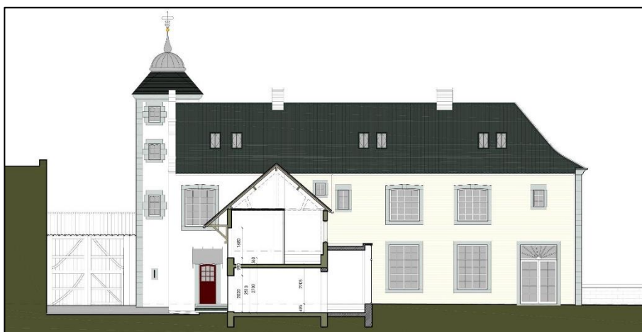
Doorsnede CC en zuidgevel
