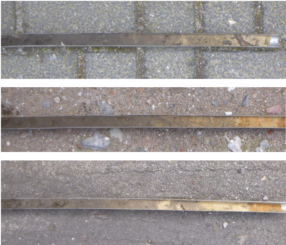
Figuur 21: Foto's van de boringen 1, 3 en 4 met de voor het plangebied kenmerkende bodemopbouw met links de toplaag van humusrijk zand en daaronder humusrijk zand met brokken geel zand en daaronder geel zand met brokken humeus zand. Geheel rechts is steeds de door oxidatievlekken gekenmerkte top van de Cg-horizont te zien.
