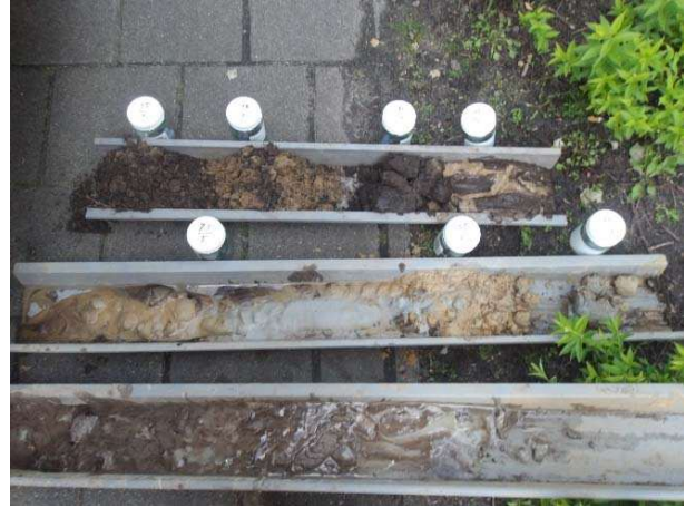
Foto 58. Profiel ondergrond boring 35
