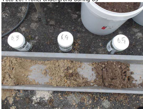
Foto 22. Profiel ondergrond boring 06
