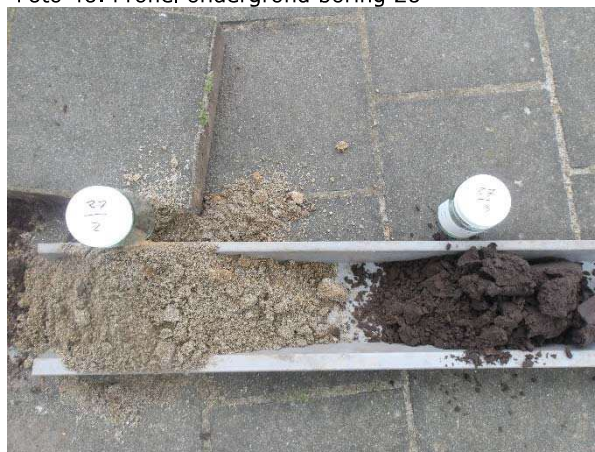
Foto 48. Profiel ondergrond boring 27
