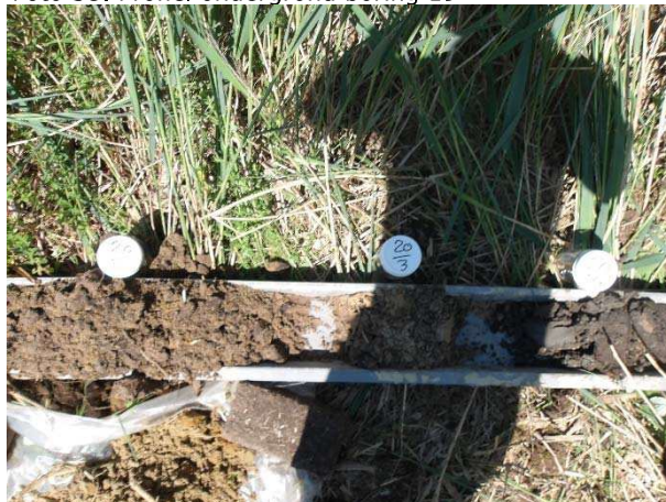
Foto 40. Profiel ondergrond boring 20
