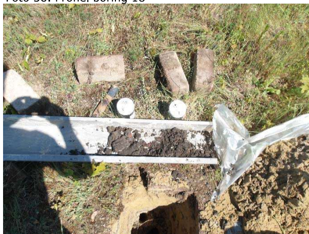
Foto 38. Profiel ondergrond boring 19
