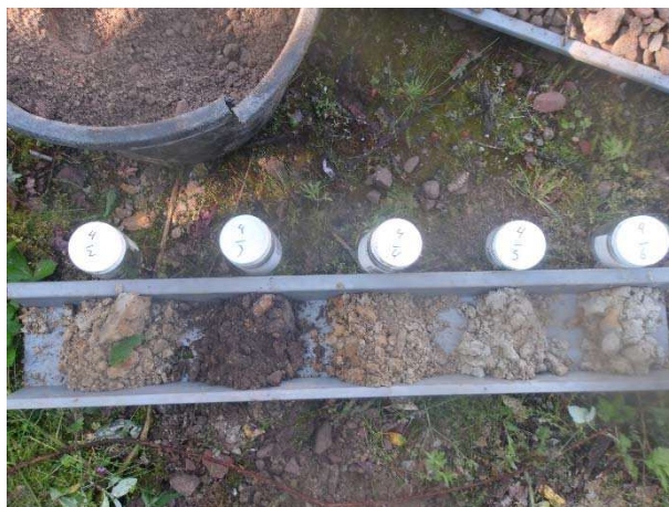
Foto 18. Profiel ondergrond boring 04
