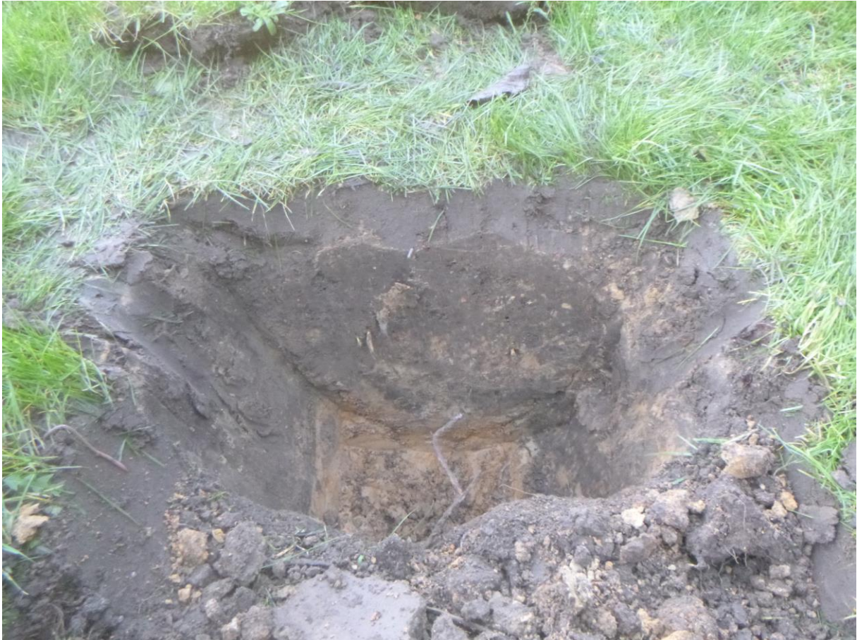
Figuur 21: Foto van het ter plaatse van boorpunt 5 gegraven kijkgat met bovenin de 35 centimeter dikke vergaven toplaag van overwegend humusrijk zand en daaronder (rechts) de door oxidatievlekken gekenmerkte top van de C-horizont.
