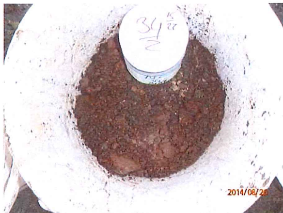
Foto 3: Bijmenging met zinkassen in de toplaag van boring 34.
