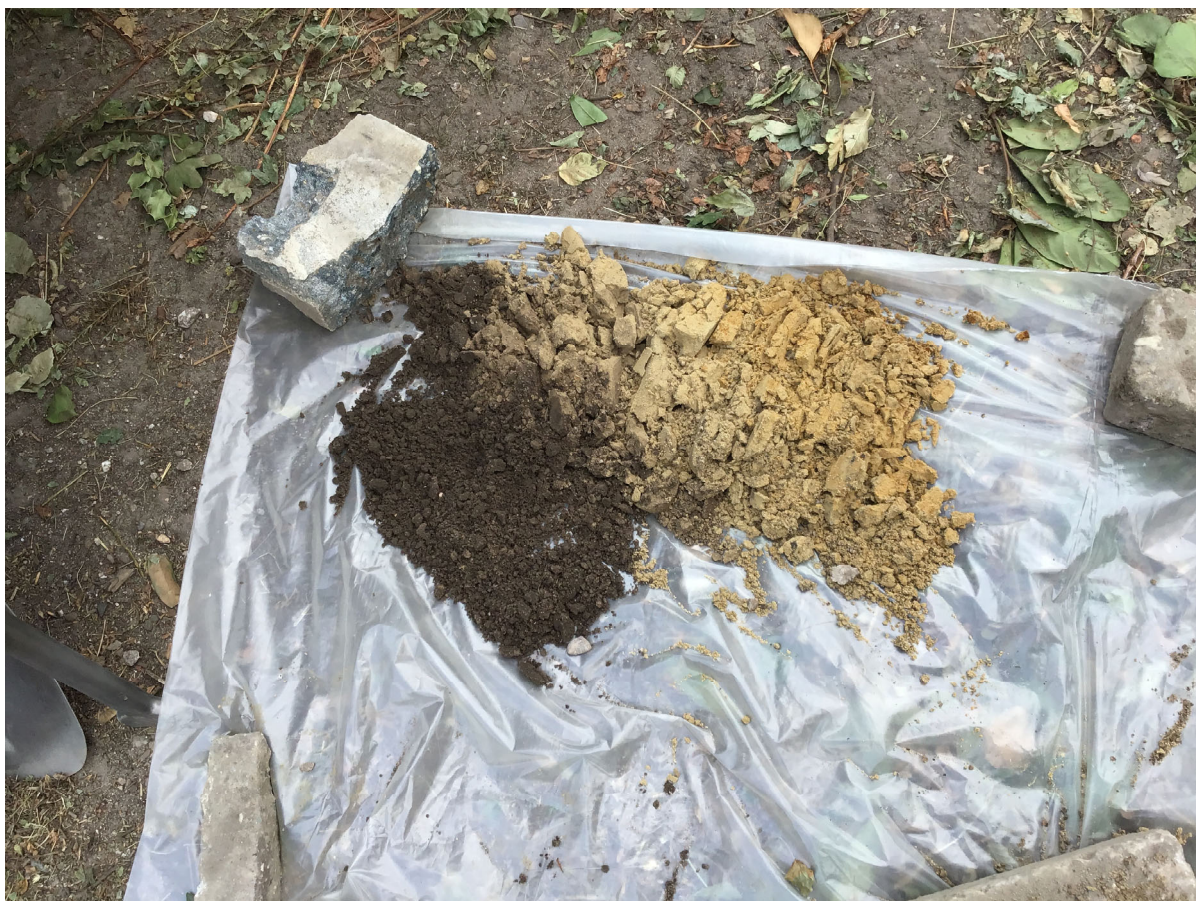
Afbeelding 12: Boring 133: Van 0 tot 90 cm bruin grijs gevlekt geroerde laag Aan-horizont, vanaf 90 cm -mv grijs gele C-horizont.
