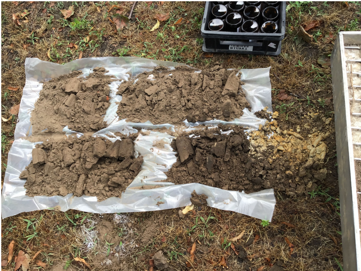
Afbeelding 10: Boring 110. 0-180 cm opgebracht pakket. Van 130 tot 250 cm restant Aan-horizont geel gevlekt met onderliggende C-horizont, vanaf 250 cm ongestoorde C-horizont.
