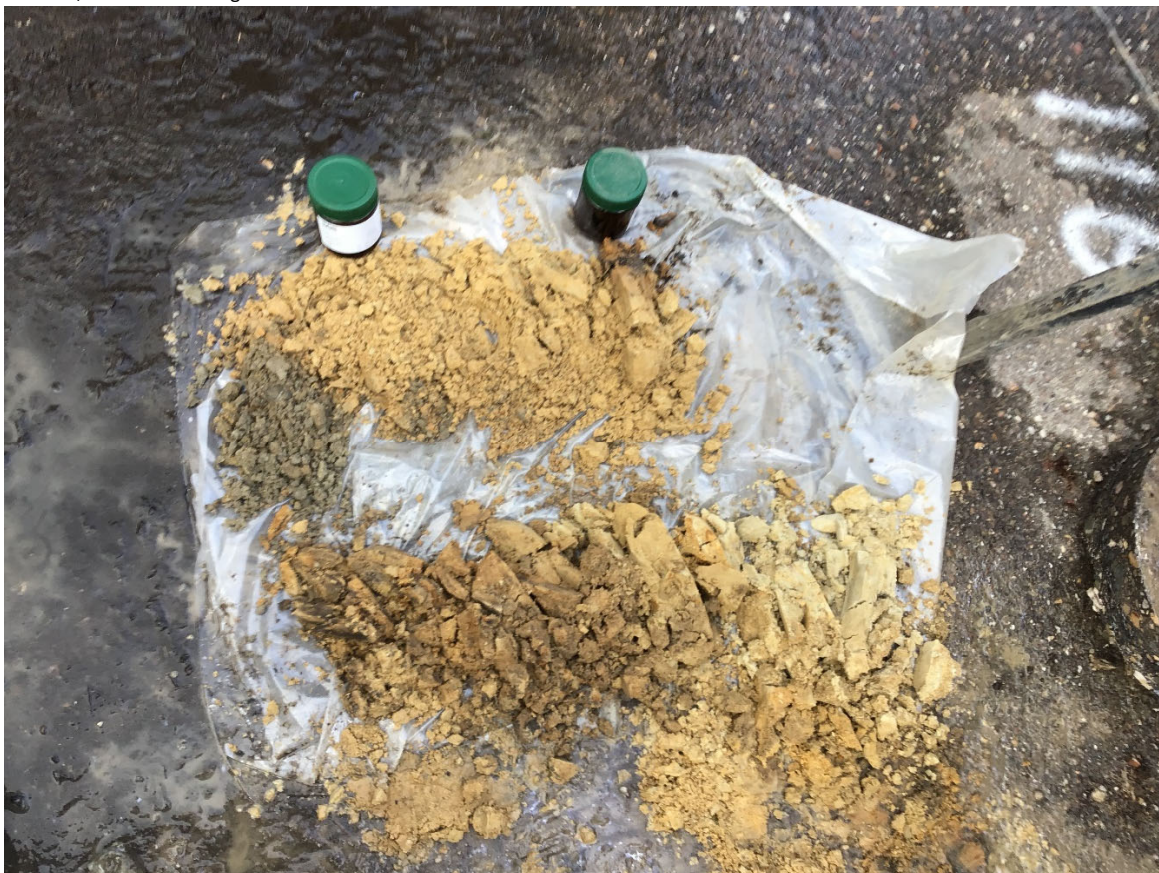
Afbeelding 11: Boring 116. Van 0 tot 60 cm opgebracht recent pakket, van 606 tot 110 geel zand, recent opgebracht pakket, 110-150 donker grijs geel gevlekt zand verstoorde Ap-horizont, vanaf 150 cm de ongestoorde C-horizont.
