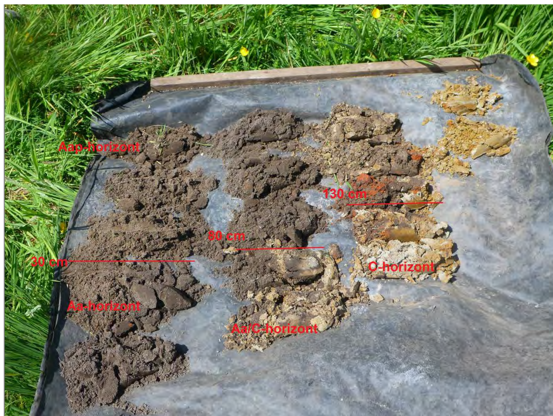
Fig. 3.1: Bodemopbouw in boring 1.
