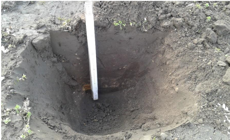
Abbeelding 14 Het profielputje met onderin lichte vlekken van materiaal uit de C-horizont. De oorspronkelijk bodem is niet bereikt (foto: Antea Group).
