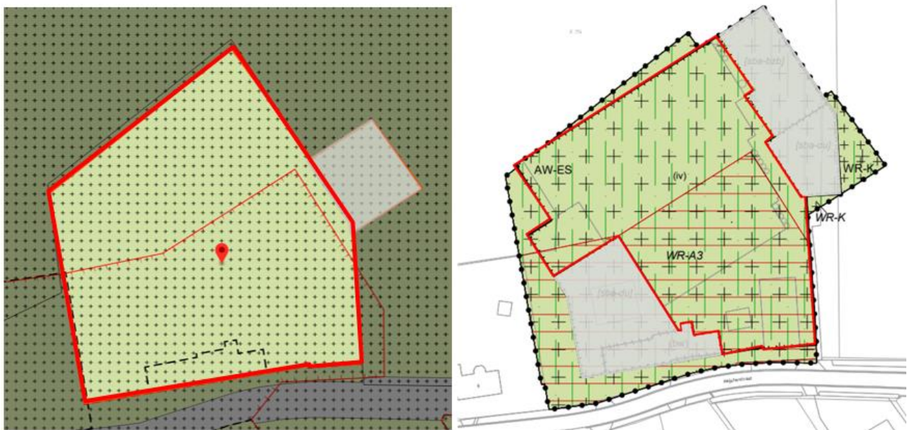
Figuur 5.2.2.: verschil tussen het bouwvlak (functie-aanduiding 'intensieve veehouderij' in het vigerend bestemmingsplan (links) t.o.v. het onderhavig bestemmingsplan (rechts) voor wat betreft te bebouwen met dierenverblijven. Binnen de rode lijn mag als zodanig bebouwd worden.
