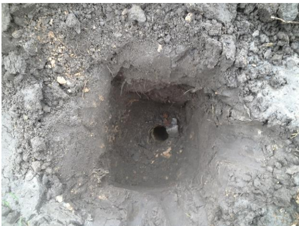
Foto 5 Boring 08 + inspectiegat hrijving
