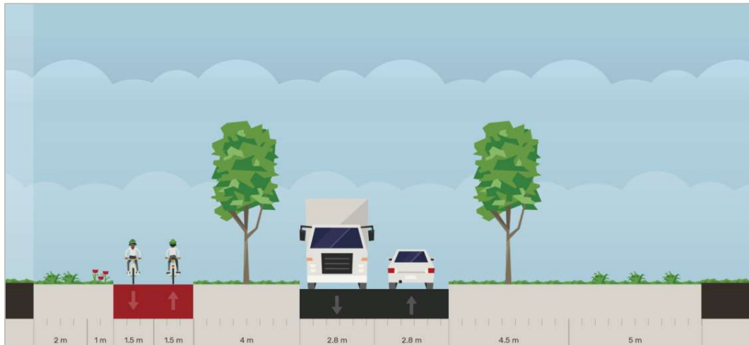
figuur 7: voorstel inrichting oprijlaan crematorium
