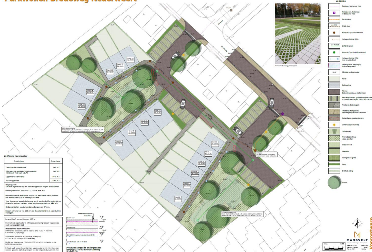
Figuur 9: Uitwerking infiltratie regenwater
