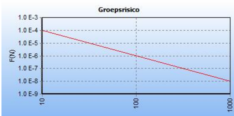
5.2 Figuur 5.2 FN curve voor 7816_leiding-A-585-deel-1 van N.V. Nederlandse Gasunie voor de kilometer tussen stationing 3990.00 en stationing 4990.00
