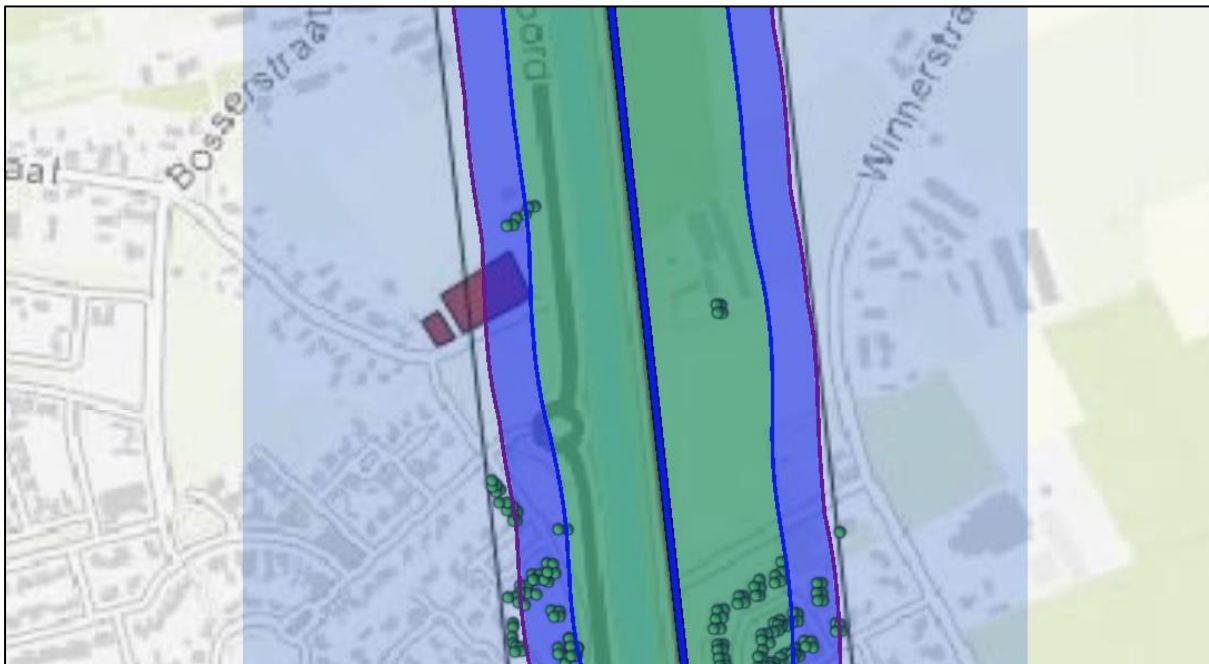
Figuur 4.2 Plaatsgebonden risico buisleiding: 10^{-8} p.j. (blauw)
