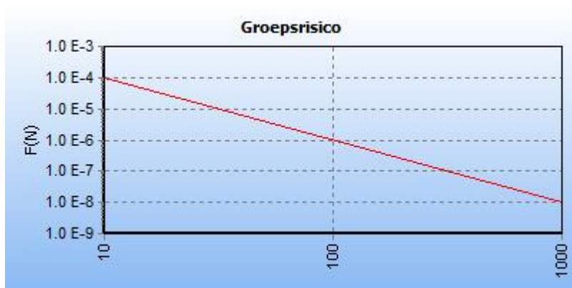
5.5 Figuur 5.5 FN curve voor 7816_leiding-Z-540-18-deel-1 van N.V. Nederlandse Gasunie voor de kilometer tussen stationing 0.00 en stationing 130.00
