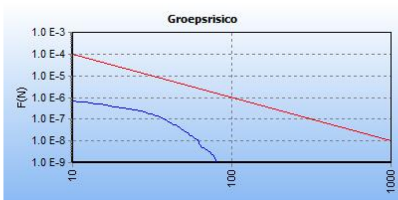
5.5 Figuur 5.5 FN curve voor 7816_leiding-Z-540-18-deel-1 van N.V. Nederlandse Gasunie voor de kilometer tussen stationing 0.00 en stationing 130.00
