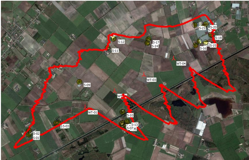
Figuur 2: ISO contour slagschaduwduur behorende bij 5 uur per jaar slagschaduw
