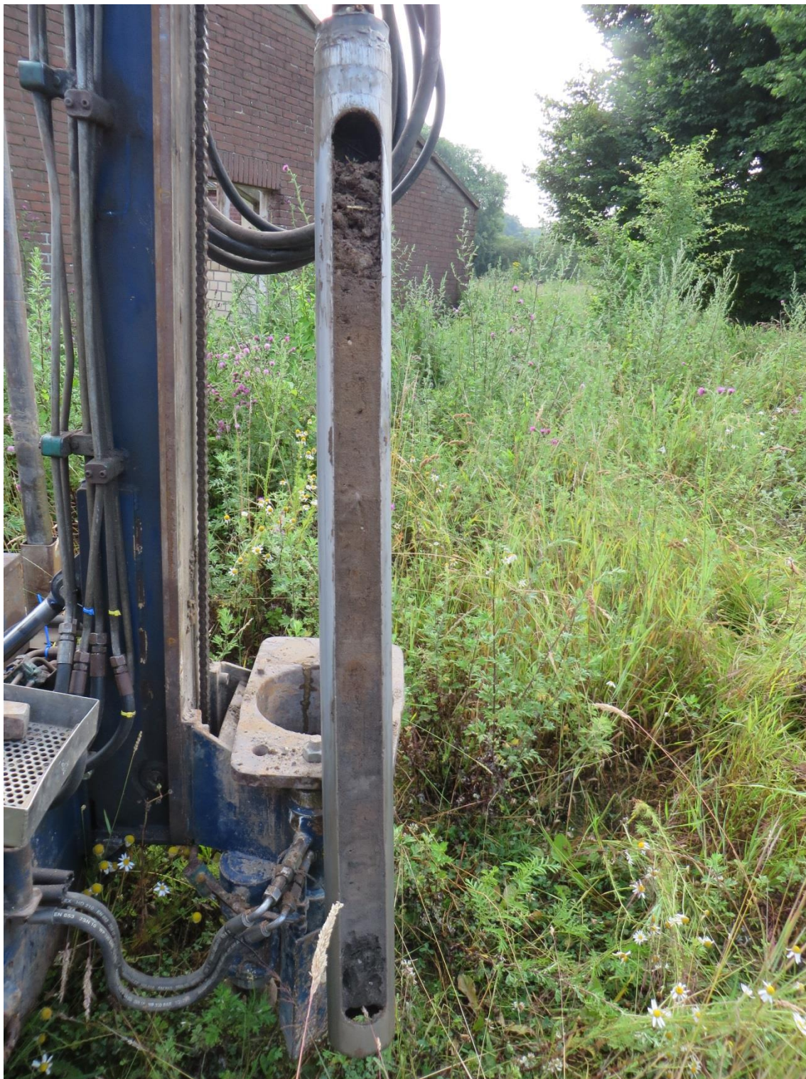
Figuur 12: Boring 7: bovengrond (0-1.5 m – mv). Deze grond is opgebracht, is los van structuur en gemêleerd van samenstelling
