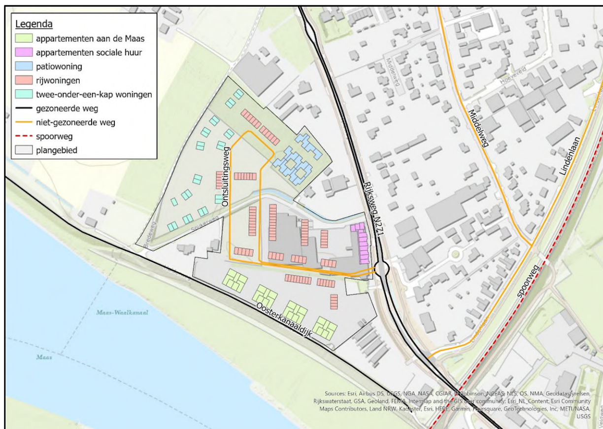
Figuur 3.1 Ligging van het plangebied met (voorlopig) bouwplan, en nabijgelegen spoorweg, gezoneerde en niet-gezoneerde wegen.
