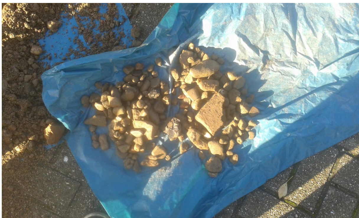
Figuur 1. Grove fractie uit proefgat 105
