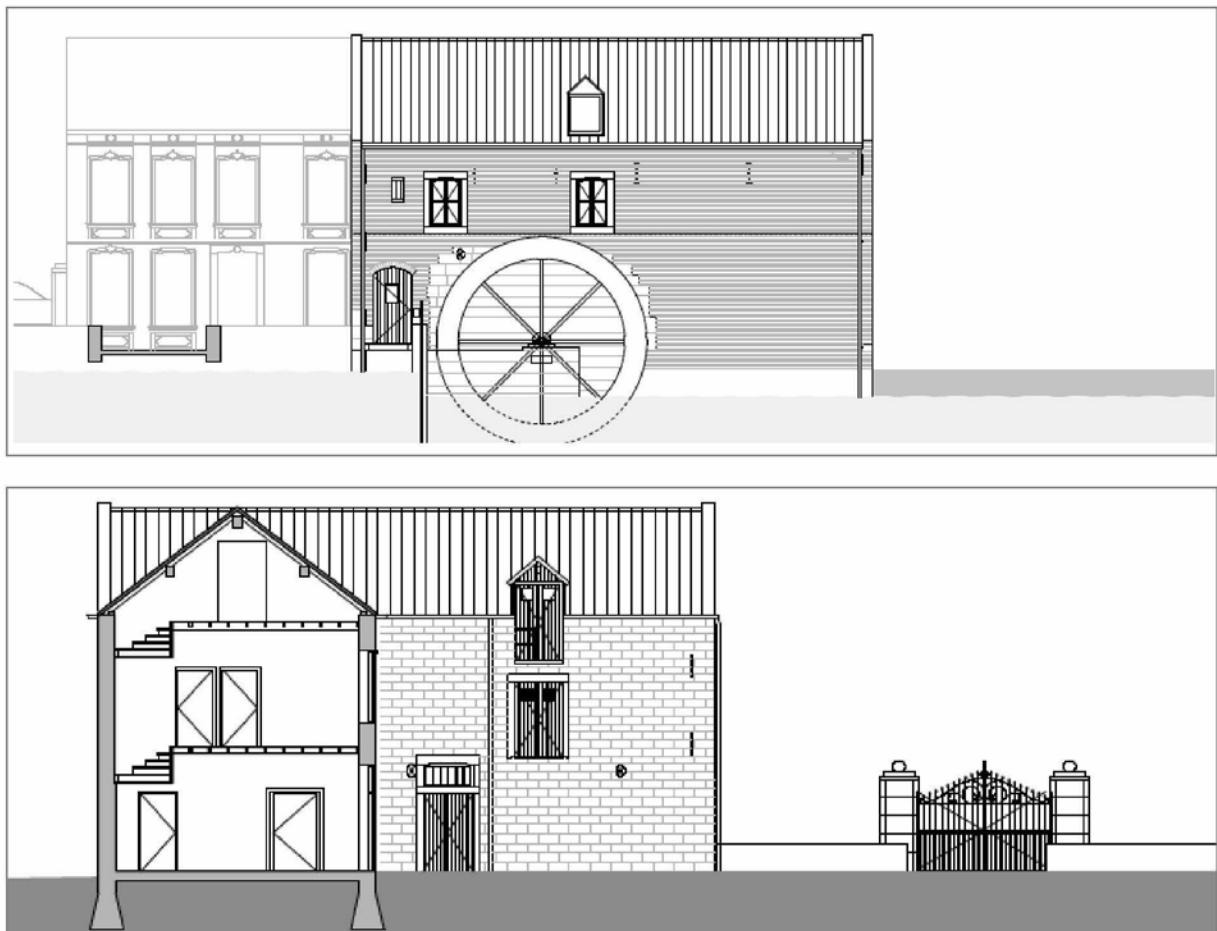
Fig. 6 Aanzicht noord- en oostgevel watermolen
