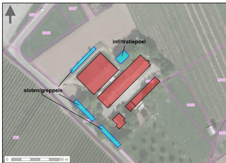
Bestaande bebouwing met de te handhaven huidige hemelwatervoorzieningen
