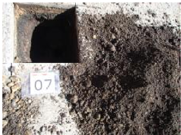
Foto 12: In proefgat 7 is een sterke bijmenging met zinkassen/slakken en kolengruis.
