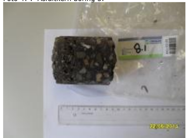
Foto 6: : Asfaltkern boring 8. Onder: STAB
