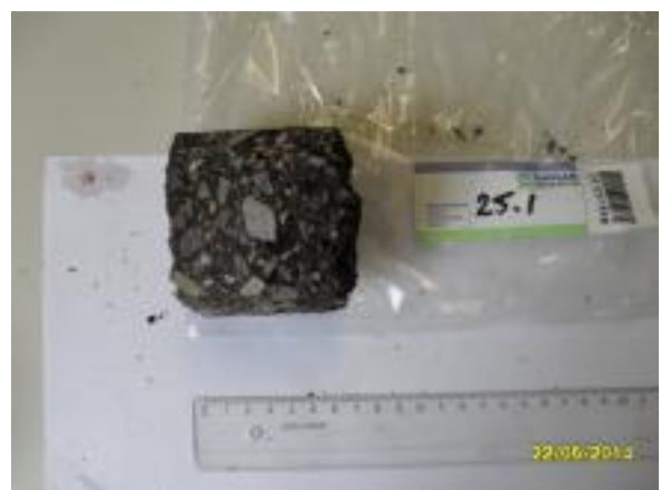
Foto 8: : Asfaltkern boring 25. Twee lagen DAB.
