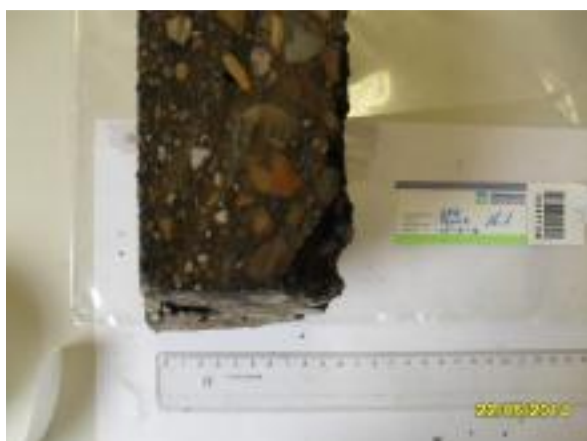
Foto 7: Asfaltkern 16: DAB en STAB (12 cm dik).
