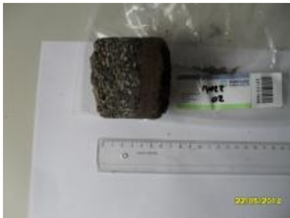
Foto 1: Asfaltkern boring 2. Boven- en onderlaag.
