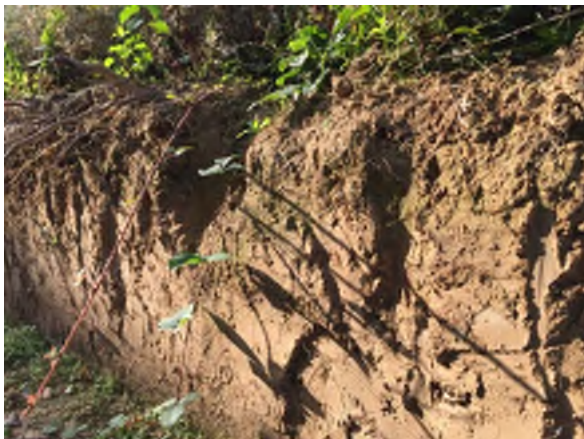
Foto 5. Een dwarsprofiel van de grondslag op het projectgebied: zwak zandige leem (löss).
