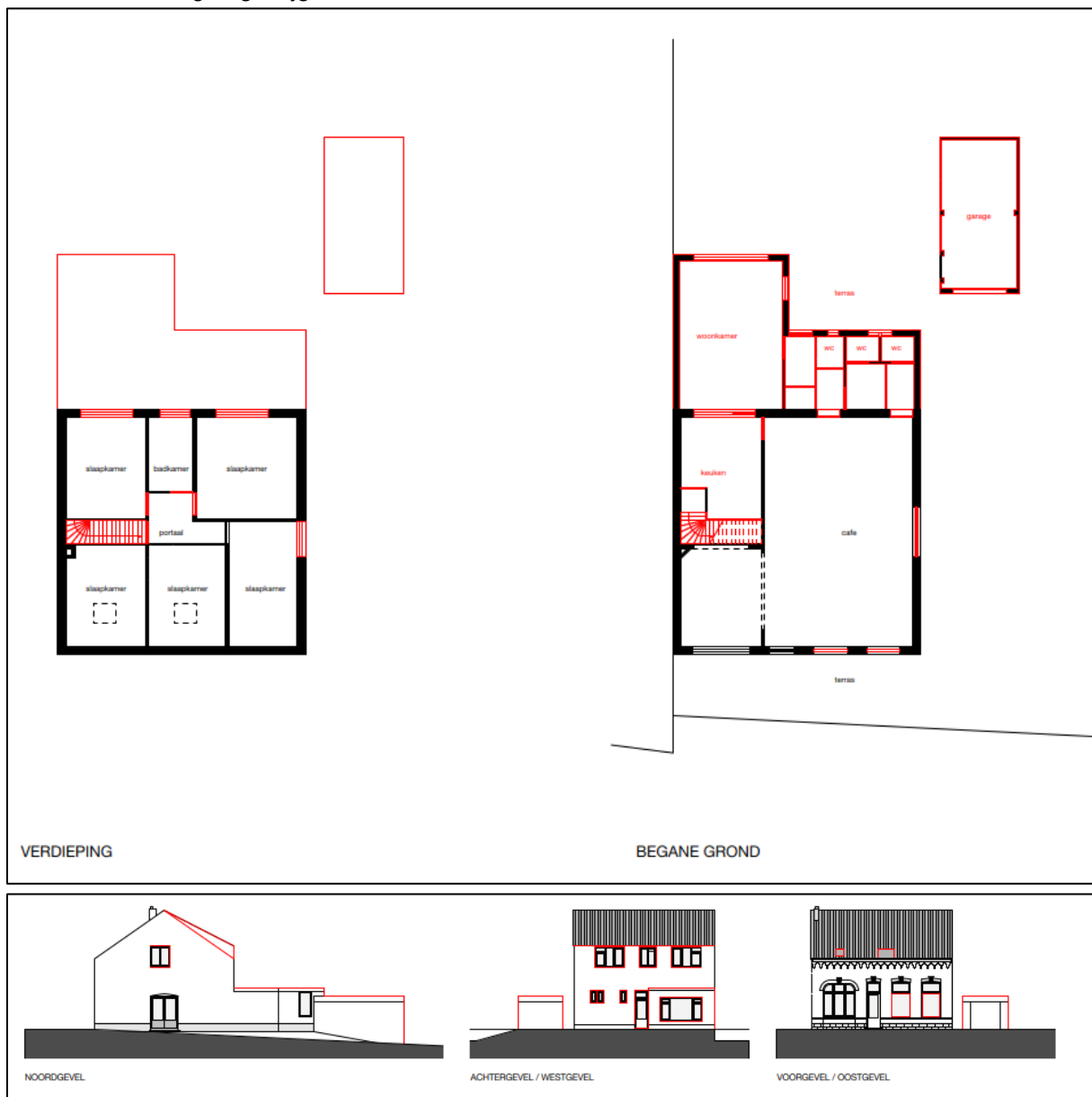
Afbeelding 5: Wijzigingen ten opzichte van 1950, inclusief aanzichten. Bron: Artesk van Royen Architecten.
