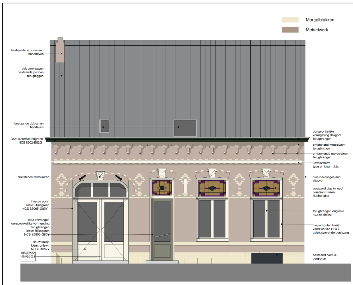
Afbeelding 13: Restauratieplan voorgevel. Bron: Artesk van Royen Architecten.
