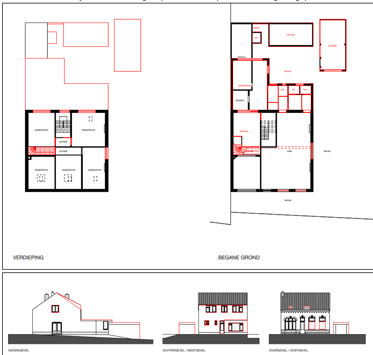
Afbeelding 4: Wijzigingen ten opzichte van 1910, inclusief aanzichten. Bron: Artesk van Royen Architecten.
