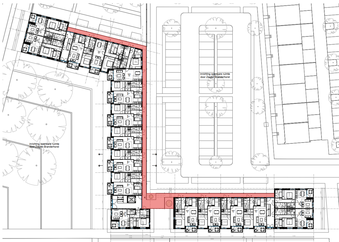
Extra brede galerij aan de achterzijde van het bouwblok waar de bewoners kunnen verblijven (rood gemarkeerd)
