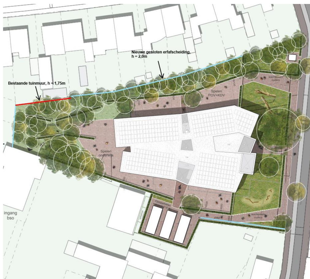
Figuur 4-2 Locaties geluidafschermende erfafscheidingen (rode lijn: bestaand, lichtblauwe lijn: nieuw)
