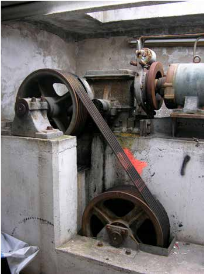
98. Het hijsmechaniek met motor
