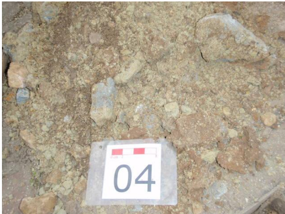
Foto 9. Materiaal asbestgat 04, matig beton
