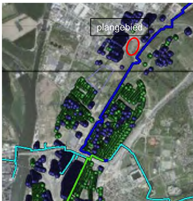
Figuur 2.3: Kilometer leiding met hoogste overschrijdingsfactor (in groen weergegeven) vóór planrealisatie
