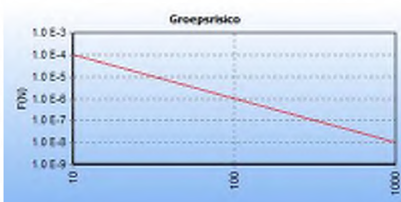
5.5 Figuur 5.5 FN curve voor 4608_leiding-Z-500-07-deel-1 van N.V. Nederlandse Gasunie voor de kilometer tussen stationing 2130.00 en stationing 3130.00
