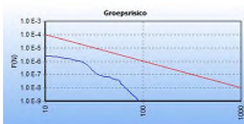
Figuur 2.6: fN-curve buisleiding Z-500-01 ná planrealisatie
