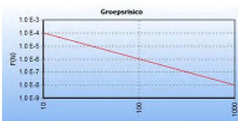
5.8 Figuur 5.8 FN curve voor 4608_leiding-Z-500-19-deel-1 van N.V. Nederlandse Gasunie voor de kilometer tussen stationing 0.00 en stationing 230.00
