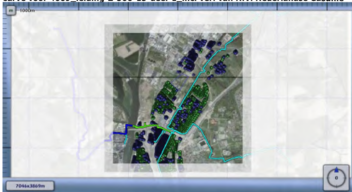
Figuur 4.13 Kilometer leiding behorende bij de maximale overschrijding van de FN-curve voor 4609_leiding-Z-500-15-deel-1_incl verl van N.V. Nederlandse Gasunie
