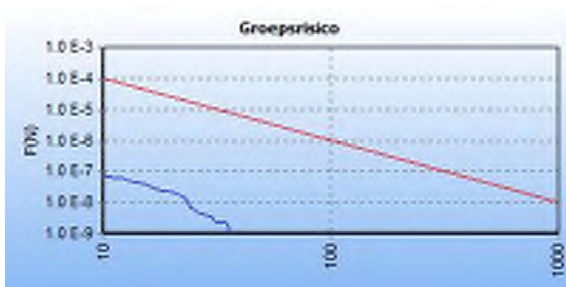
5.13 Figuur 5.13 FN curve voor 4609_leiding-Z-500-15-deel-1_incl verl van N.V. Nederlandse Gasunie voor de kilometer tussen stationing 0.00 en stationing 1000.00
