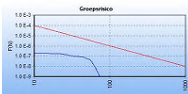
5.5 Figuur 5.5 FN curve voor 4608_leiding-Z-500-07-deel-1 van N.V. Nederlandse Gasunie voor de kilometer tussen stationing 2130.00 en stationing 3130.00
