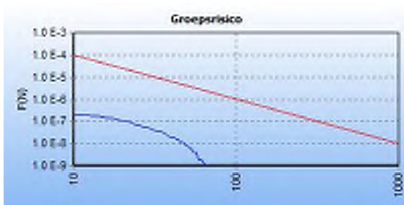
5.8 Figuur 5.8 FN curve voor 4608_leiding-Z-500-19-deel-1 van N.V. Nederlandse Gasunie voor de kilometer tussen stationing 0.00 en stationing 230.00
