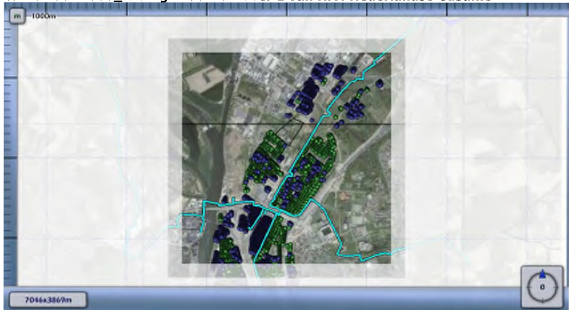
Figuur 4.9 Kilometer leiding behorende bij de maximale overschrijding van de FN-curve voor 4608_leiding-Z-501-01-deel-1 van N.V. Nederlandse Gasunie
