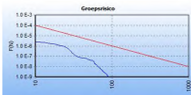
Figuur 2.5: fN-curve buisleiding Z-500-01 vóór planrealisatie
