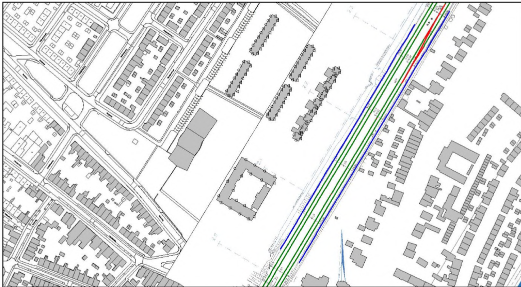
Figuur 4.2: Situering scherm 1,5 meter hoog
