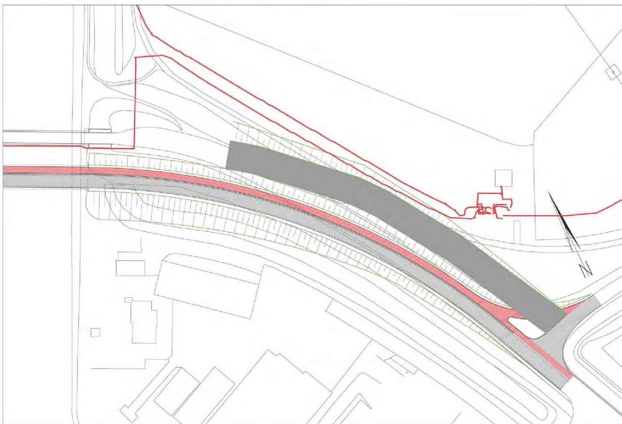
Figuur 4.4 Aanduiding gasleiding t.o.v. tijdelijke situatie.
