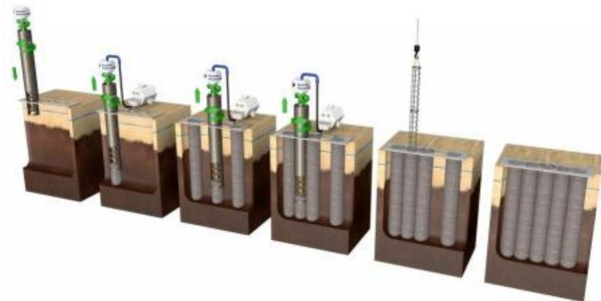
Figuur 4-3: Uitvoeringsvolgorde schroefpalenwand. (bron: www.ffgb.be )
