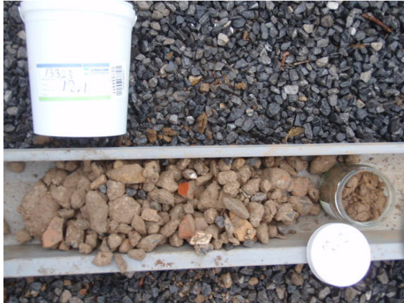
Foto 9: proefgat 07 t/m 12 korrelmixverharding.
