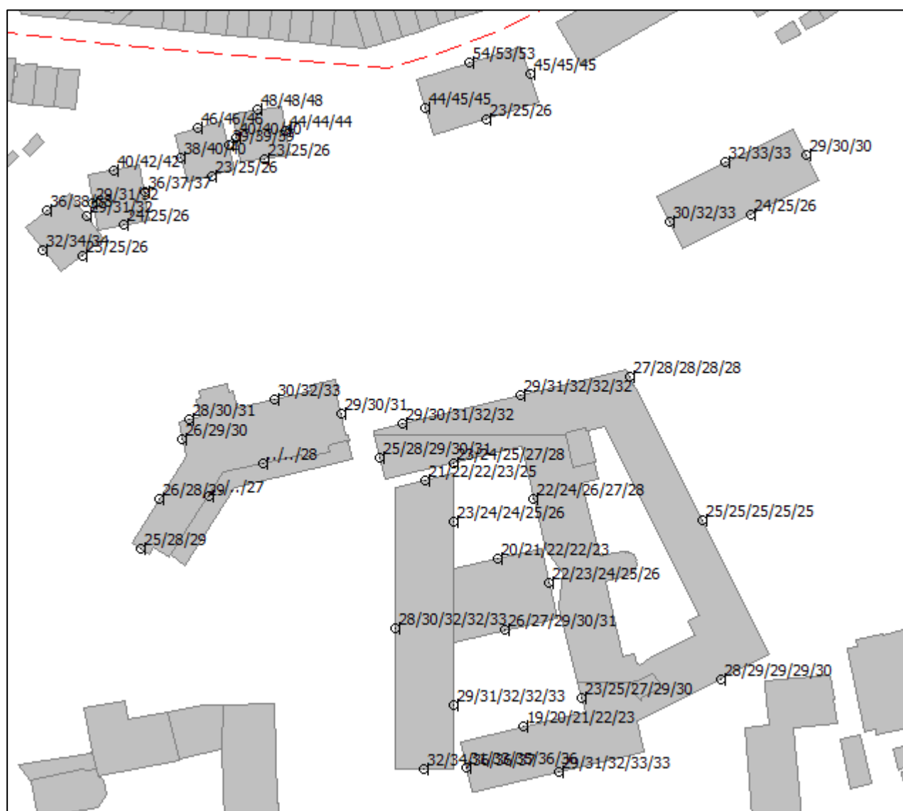
Figuur 5.3: Geluidbelasting ten gevolge van wegverkeer op de omliggende 30 km/u wegen incl. aftrek conform artikel 110g Wgh
