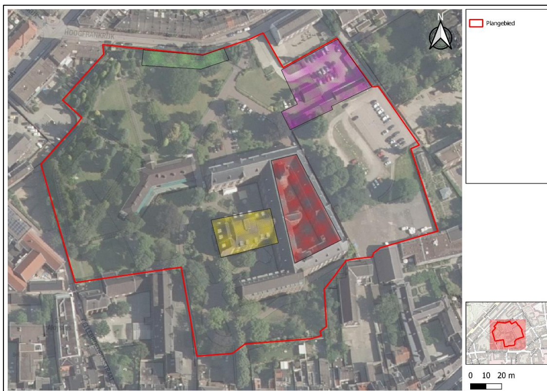
Figuur 3: Plangebied (rood) ingrepen: te kappen bomen (groene dwarsstroken), te slopen gebouwen (roze dwarsstroken), te slopen seniorengebouw (gele dwarsstroken) en de te overdekken binnentuin waar een luchtbrug komt (rode dwarsstroken).
