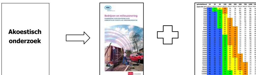
Figuur 3: schematisch overzicht: neem de geluidsproductie uit het akoestisch onderzoek – vergelijk die met de waarde volgens 'Bedrijven en milieuzonering' en de tabel.
