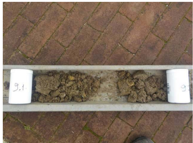
Foto 2: Sterke bijmengingen puin en stuit in talud in boring 9. Licht verontreinigd met zink.
