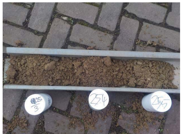
Foto 6: Bodem onder puinggranulaat in boring 22-24 is schoon tot 1,7 m-mv en in 25 tot 1,0 m-mv. Daaronder is koper > Iw.
