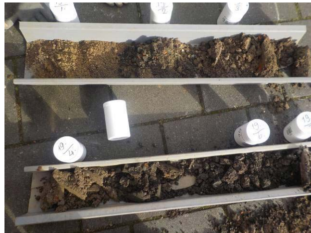
Foto 4: Ondergrond onder trottoir is sterk verontreinigd met zink en plaatselijk ook met PAK en minerale olie.
