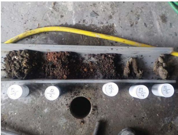
Foto 3: Bovengrond onder woningen sterk verontreinigd met zink. Onder woningen 56-70 is een baksteenlaag met industriële slakken. Ondergrond licht verontreinigd.
