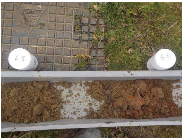
Foto 1: Voorbeeld profiel in talud met bijmengingen baksteen (boring 6) of puin (boring 4 en 5) in ondergrond. Niet tot licht verontreinigd met zink.
