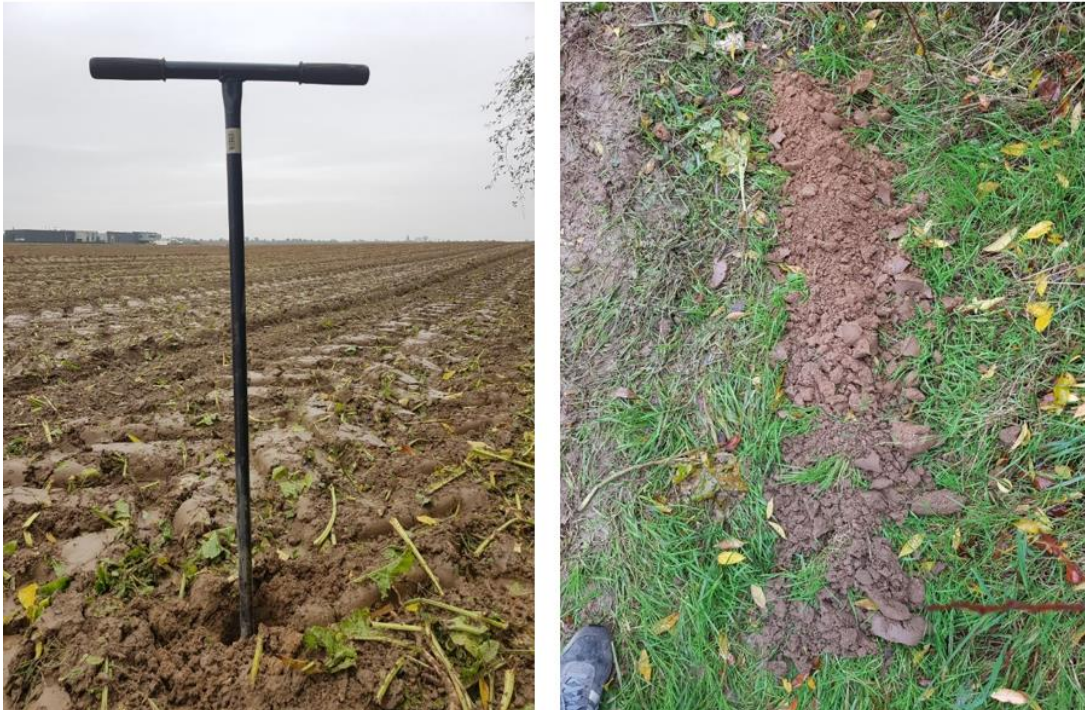
Figuur 2 Boorprofiel in plangebied Lanakerveld. Sweco november 2019
