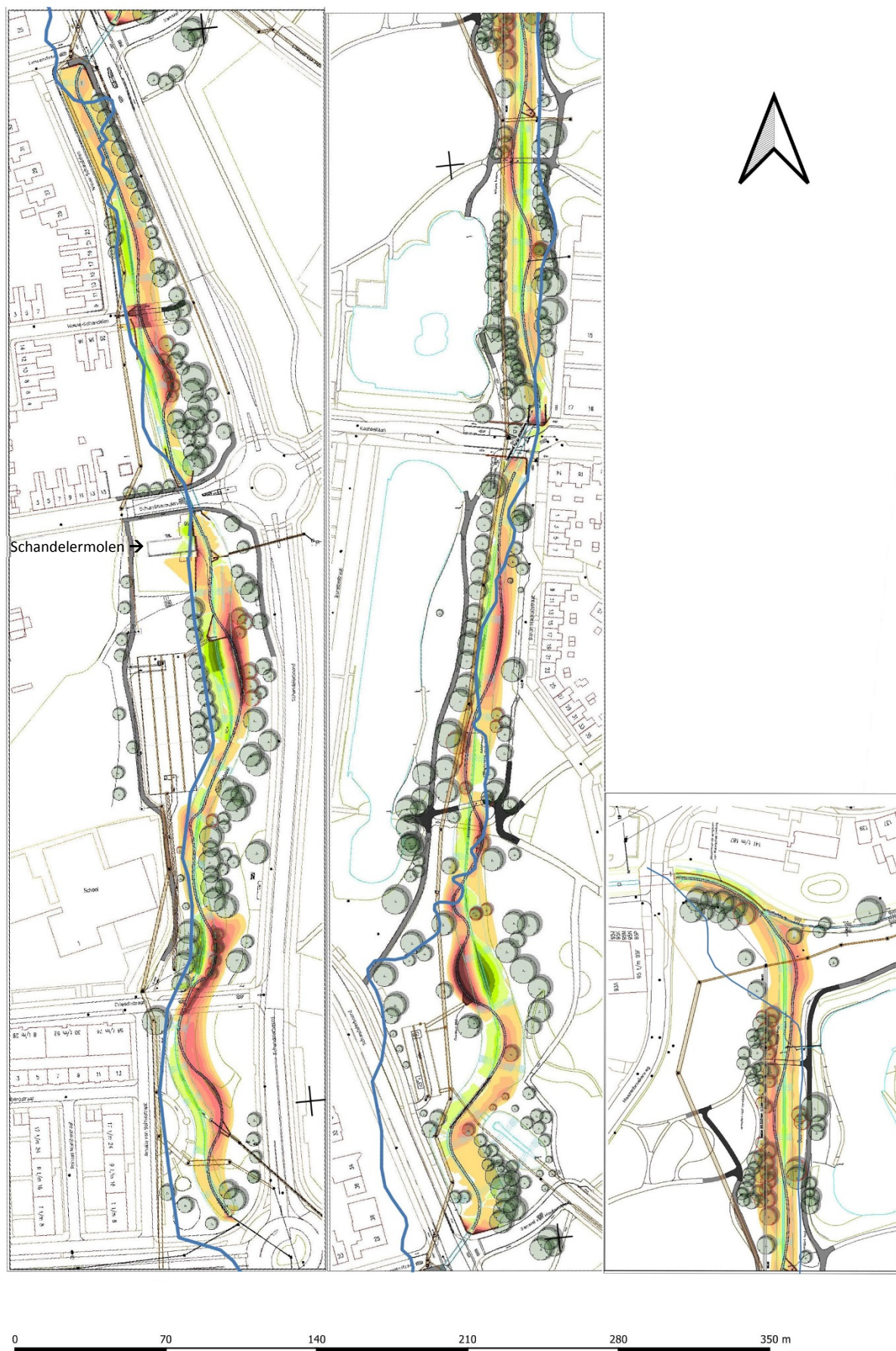
Afbeelding 2.5: De oude loop van de Caumerbeek (blauwe lijn) zoals aangegeven op de kadastrale kaart uit 1832, geprojecteerd over de geplande werkzaamheden voor de herinrichting van de Caumerbeek.
