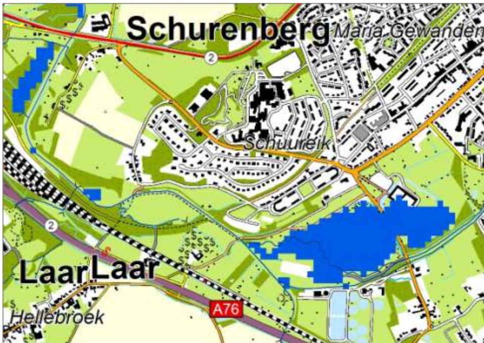
Figuur 3.8: Inundatiepatroon bij T=25 afvoer in de heringerichte situatie
