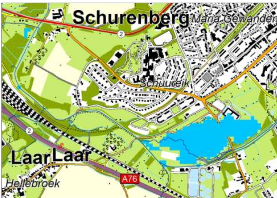
Figuur 3.7: Inundatiepatroon bij T=10 afvoer in de heringerichte situatie
