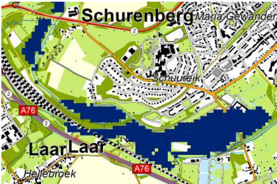
Figuur 3.5: Inundatiepatroon bij T=100 afvoer in de actuele situatie
