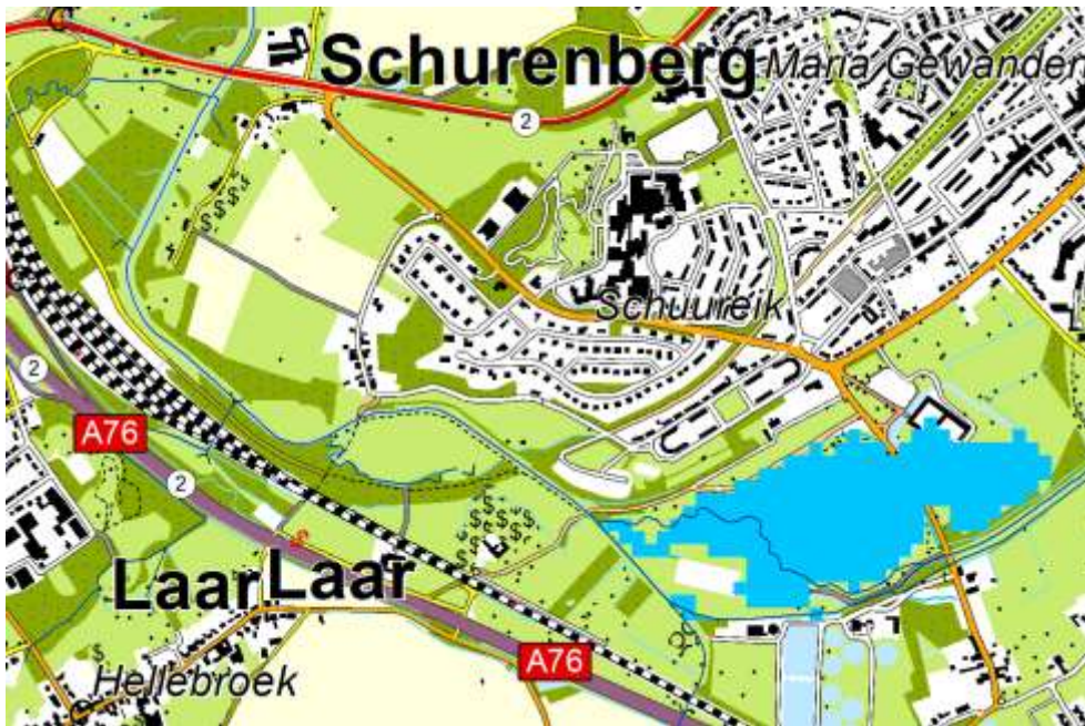
Figuur 3.3: Inundatiepatroon bij T=10 afvoer in de actuele situatie
