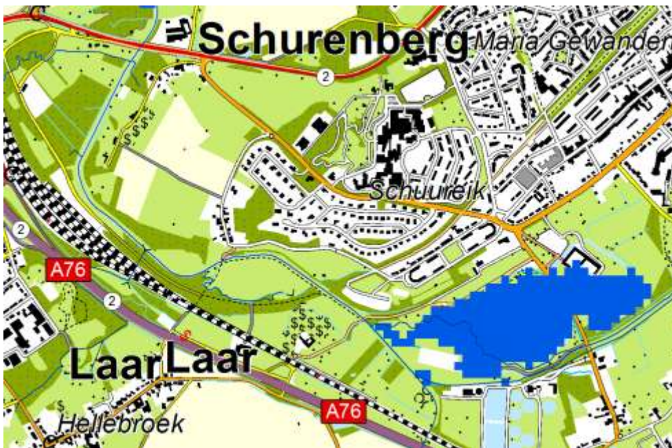
Figuur 3.4: Inundatiepatroon bij T=25 afvoer in de actuele situatie
