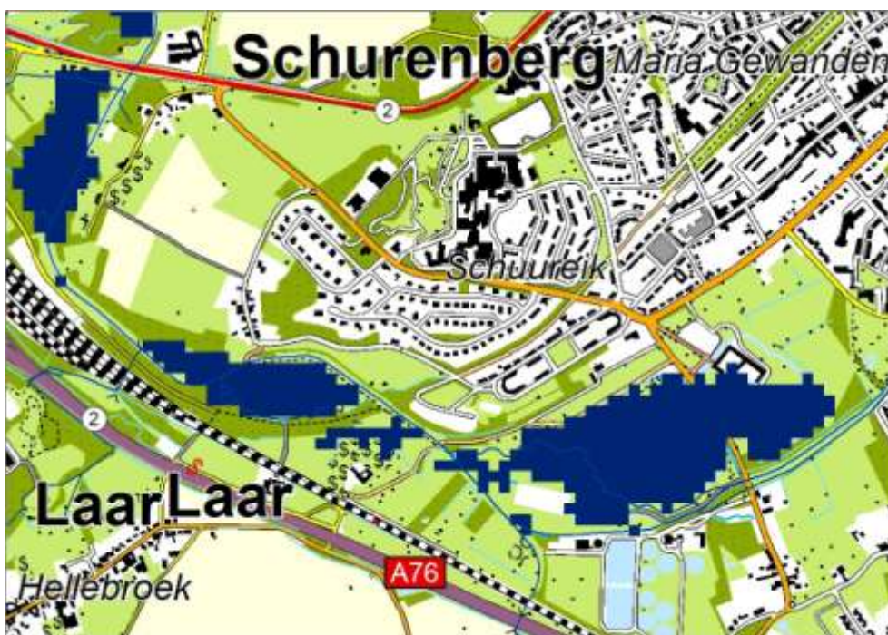
Figuur 3.9: Inundatiepatroon bij T=100 afvoer in de heringerichte situatie
