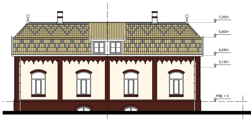
bestaande toestand voorgevel
